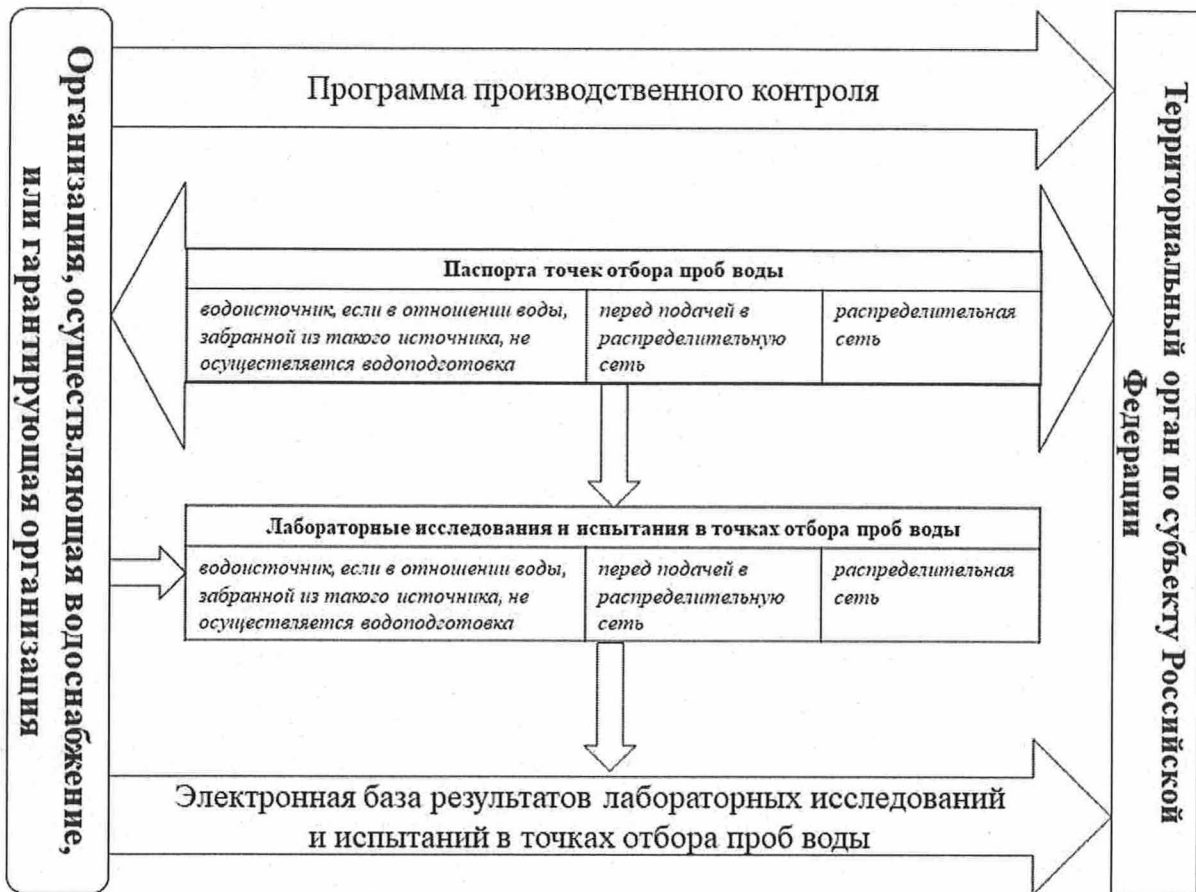
Рисунок 1. Процедура сбора результатов производственного контроля качества и безопасности питьевой воды в информационную систему контроля качества питьевой воды в Российской Федерации
